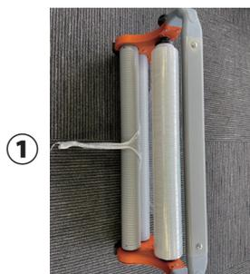
① 先を丸めてローラー間に差しローラーを手で回すと先端が出てきます。
